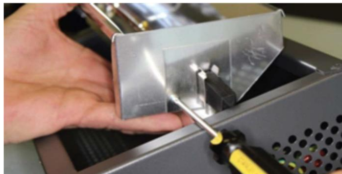
Fig. 3 Fjern sidestykkene på reflektoren.
